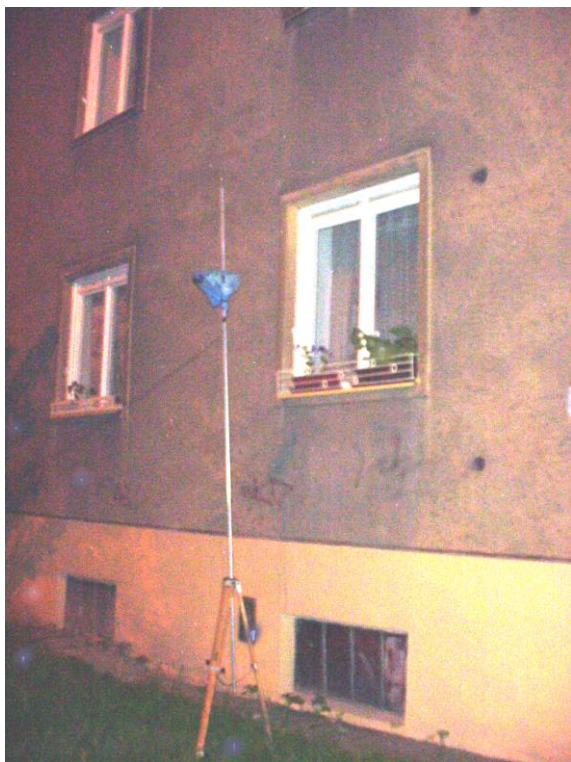
Obr.2 Umístění hlukoměru před oknem bytu.
